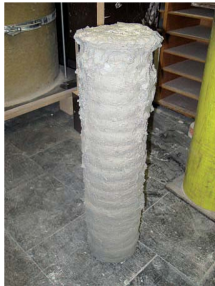
Bild 4 Ausgebaute Trockenmörtelsäule (die gewellte Oberfläche entspricht den einzelnen Arbeitsschritten beim Einbau und Verdichten des Trockenmörtels) Stripped dry mortar column (the rippled surface reflects the stages of fabricating and compacting dry mortar)
