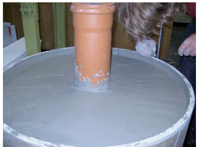
Bild 1 Versuchsstand mit Platzhalter (KG-Rohr) und bereits eingebautem Versuchsboden Test station with placeholder (PVC-pipe) and prepared soil
