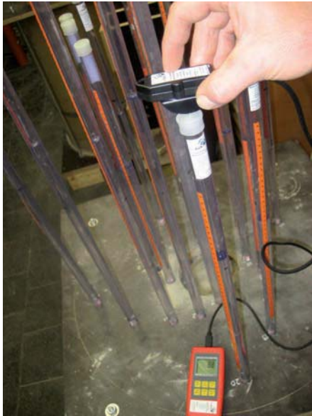
Bild 2 Versuchsstand mit Tensiometern Test station with tensiometers
